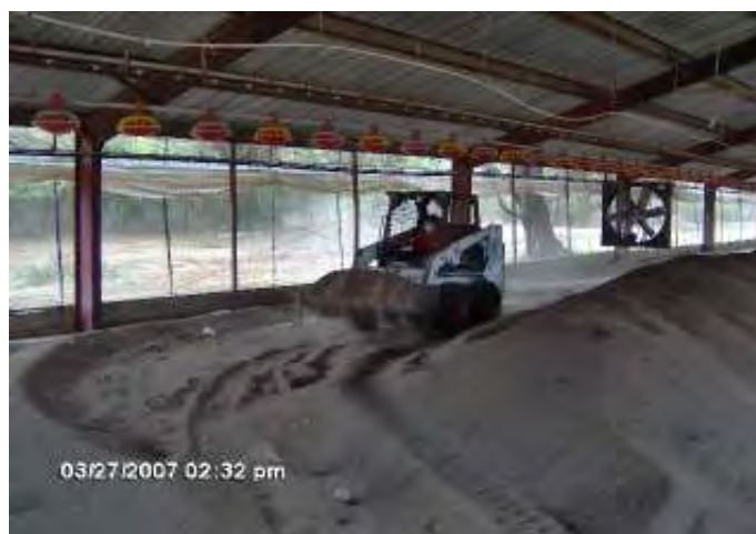
Figura 4.05. Procedimiento para la remoción de gallinaza dentro del galpón con maquinaria pesada.
