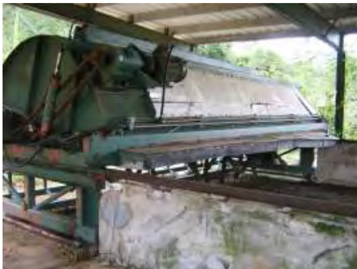
Figura 2.02. Maquinaria utilizada para generar abono orgánico de la gallinaza. Este sistema se llama Compost- A- Matic.
