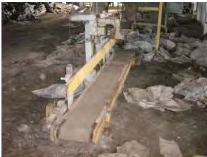
Figura 2.04. Maquinaria de empaque y pesada del abono orgánico.
