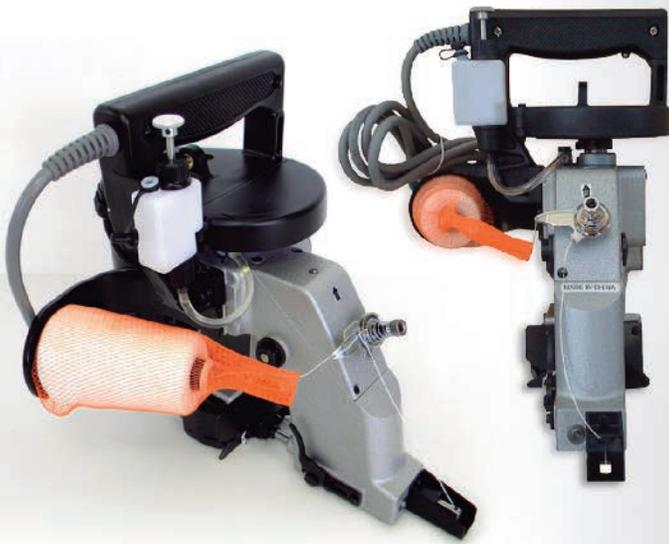
La cosedora portátil para banda de huevo es ideal para reparar y mantener las bandas de polipropileno. Además, está equipada con un sistema automático de lubricación que permite prolongar la vida útil de la misma.
